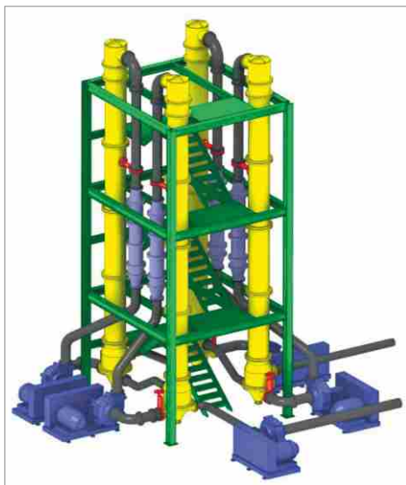
Рис. 2. Схема комплекса колонного выщелачивания с реакторами Aachen
