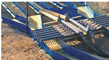
Рис. 3. Кавитатор на сопряжении пульповода со шлюзами предназначен для торможения потока пульпы встречными струями воды, которая поступает из общей системы подачи комплекса
